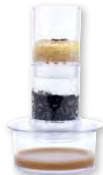
minimaler zweistufiger Filter mit Sand und Aktivkohle
