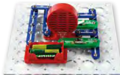
Experiment: Türklingel mit Druckschalter
