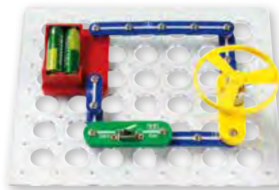
Experiment: Strom erzeugt Bewegung
